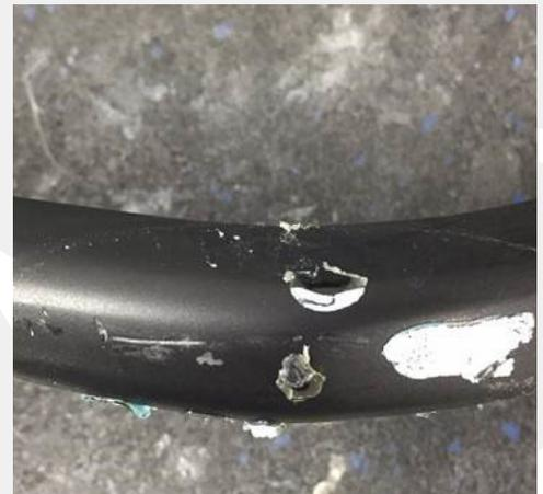
**3.** Utilisez un tampon d'alcool isopropylique pour enlever les morceaux de colle qui peuvent rester sur le carbone ainsi que pour le nettoyer.
