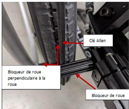
4. Visser les 2 vis de la bague sur le cadre et finaliser l'installation avec la clé dynamométrique ajustée à 7 Nm pour la bague en carbone et à 12 Nm pour le cadre en aluminium.
