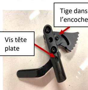
**UNE VÉRIFICATION RÉGULIÈRE DE CET AJUSTEMENT EST NÉCESSAIRE AFIN DE CONSERVER L'INTÉGRITÉ DU SYSTÈME D'ANTI-RECU.**
