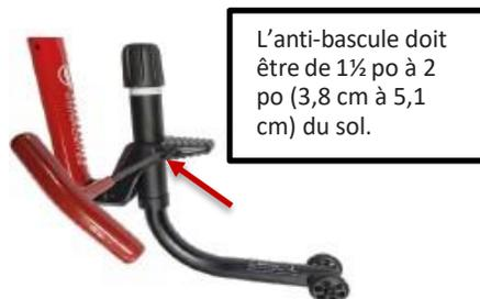
L'anti-basculé doit être de 1½ po à 2 po (3,8 cm à 5,1 cm) du sol.
