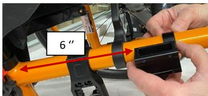
6. En ajustant la tension des vis de 4 mm avec la clé Allen, s'assurer que l'appui-bras est parallèle au dossier.
