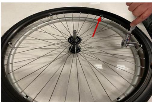
3. Changer le cerceau de roue en alignant bien les trous avec ceux de la roue.
