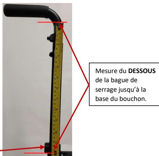
2. Prendre la mesure du **DESSOUS** de la bague de serrage jusqu'à la base du bouchon peu importe la hauteur de la canne.
