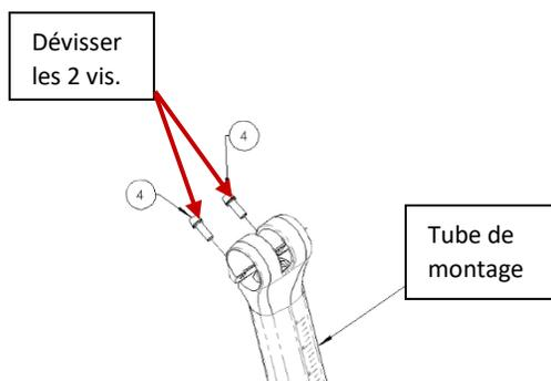
3. Utiliser 1 des 2 vis et l'insérer dans le trou fileté situé entre les 2 vis pour permettre à la bague de s'ouvrir et de déplacer le tube de montage plus facilement à l'endroit voulu.
