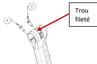
4. Retirer la vis du trou fileté et revisser à leur position d'origine les 2 vis avec la clé dynamométrique ajustée à 7 Nm en alternant d'une vis à l'autre.
