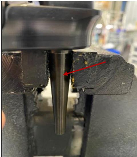
2. Mettre 1 goutte de frein filet sur la pointe de la tige et y visser le bâti de roue.
